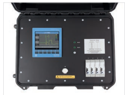
Abb.: MRG 512-PRO PQ Flex – Mobiler Spannungsqualitätsanalysator mit RCM (Abb. ähnlich)
