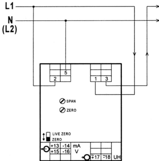
Type MWg-4.1 MF (Vierleiterdrehstrom gleich belastet)
