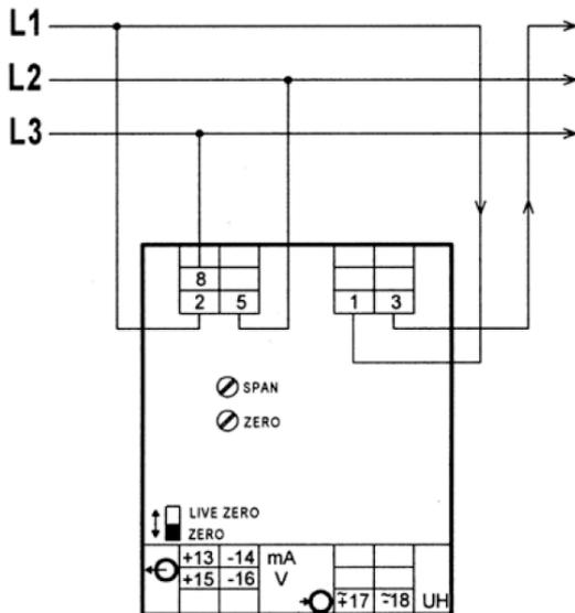
Bei Geräten mit Frequenzmodul entfallen weitere Ausgänge. An den Klemmen +13 und -14 steht der Frequenzausgang zur Verfügung
